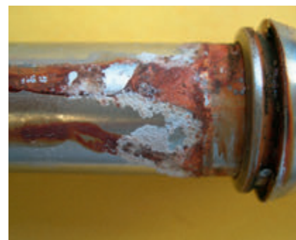
Abbildung eines Niedrigpreisprodukts: Korrosionsschaden durch eine minderwertige Härtung des hinteren Klemmrings
