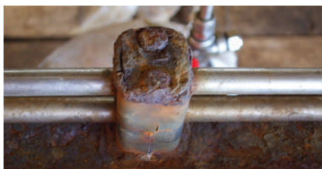
Spaltkorrosion an der Schnittstelle Rohr/Rohrschelle.
